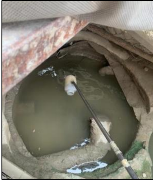
รูปที่ 3.4-2 การเก็บตัวอย่างคุณภาพน้ำ บริเวณระบบบำบัดน้ำเสียสำเร็จรูป
